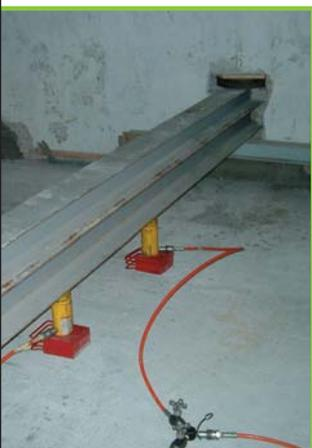
Prove di carico di travi portanti lignee. In un edificio storico di Roma, dopo il rinforzo strutturale con barre pretese, è stato misurato l'incremento di rigidità delle travi con una prova di carico ciclica. La struttura di contrasto è stata realizzata con travi metalliche incastrate nella muratura al di sopra della trave rinforzata.
